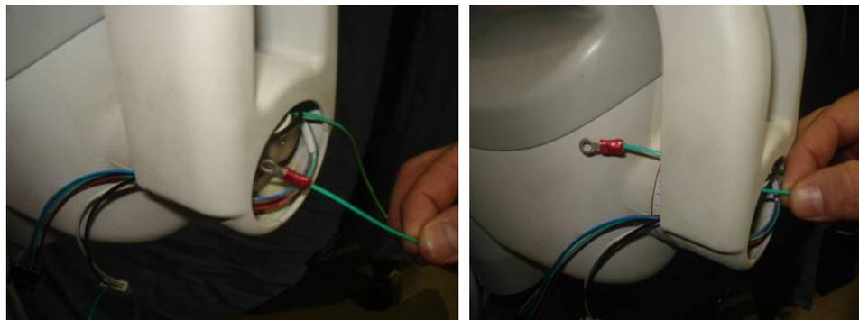
31. Volver a conectar los dos cables a tierra que se retiraron en el paso 6.
