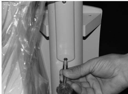
19. Retirar el tornillo que asegura la placa lógica. Mover hacia afuera la placa lógica y hacer las tres conexiones como se muestra a continuación.
